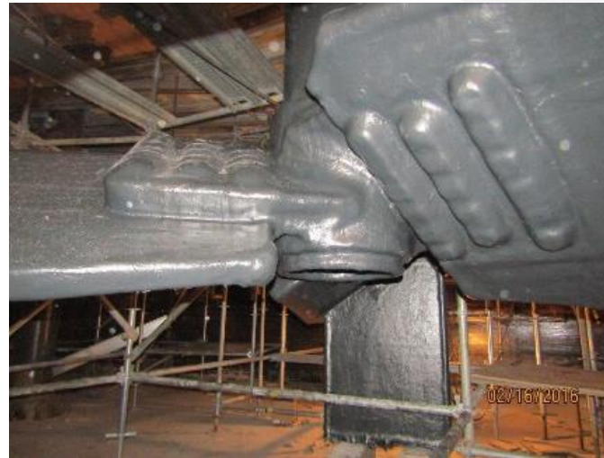
Agitador revestido com DERAKANE com SiC
