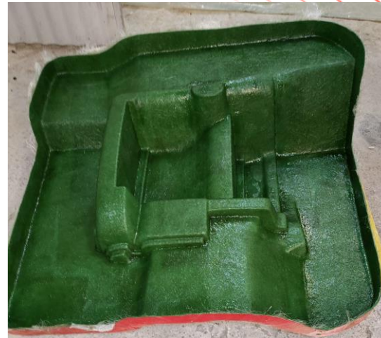
Após o Gel Coat, 1ª. Camada Estervinílica
