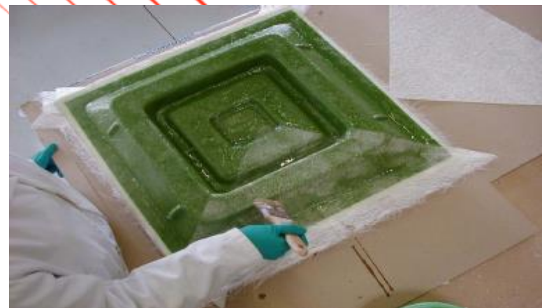
1 camada Manta 450 g/m 2 + Resina Estervinílica
