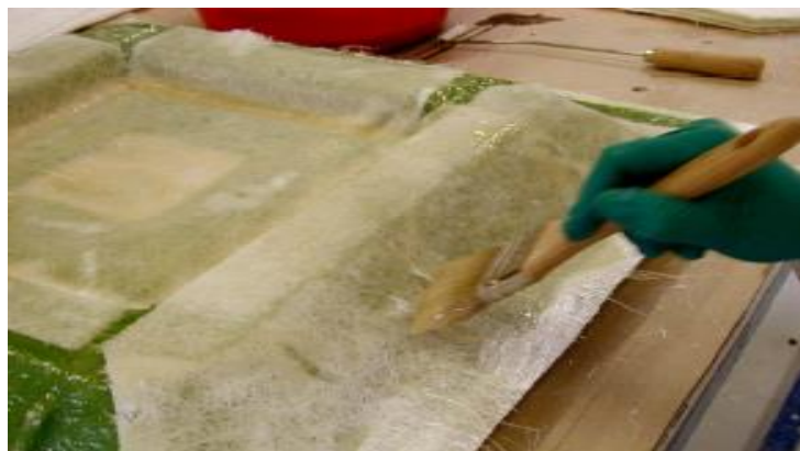
4 camadas Manta 450 g/m 2 + Composto de Moldagem BX0® Morquímica em apenas uma etapa de laminação – Opção Laminação “Spray-Up”
